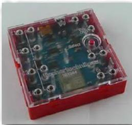
■ Контроллер BT Smart — это сердце вашего конструктора. Внутри контроллера находится несколько микросхем и микропроцессор. Взаимодействие этих компонентов с компьютером и управляющей программой позволит управлять моделями.
