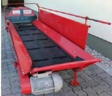
■ Конвейер обычно представляет собой стационарное устройство, и используется в горнодобывающей промышленности, при строительстве тоннелей, на промышленных предприятиях для транспортировки заготовок, изделий и т.д. Конвейер состоит из основания, на котором установлены различные элементы для обеспечения движения конвейерной ленты: шестерни, подшипники, приводы, моторы, различные устройства для обеспечения безопасности и т.д.
