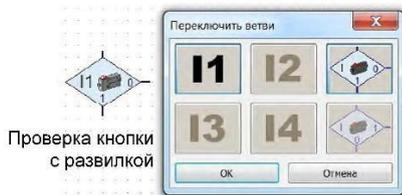
В этот раз для опроса переключателя используйте программный блок «Проверка кнопки с развилкой». У этого блока три соединительных вывода. Он работает следующим образом: если кнопочный переключатель не нажат, то программа переходит на соединительную линию, подключенную к выходу 0. Если переключатель нажат, тогда программа идет на выход 1.
